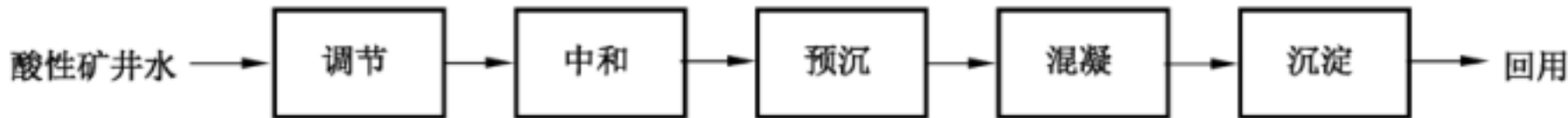
图 D.1 酸性矿井水处理后回用于选煤或选矿生产用水基本处理工艺
