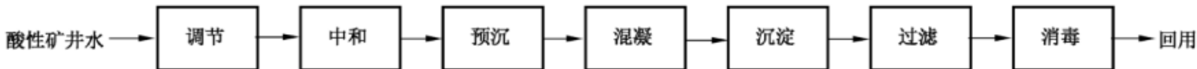
图 D.2 酸性矿井水处理后回用于矿区井下或地面洒水、防尘、消防、洗车及机修厂设备清洗用水基本处理工艺
