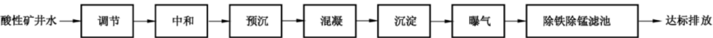
图 D.10 高铁锰酸性矿井水中和法+接触氧化法基本处理工艺
