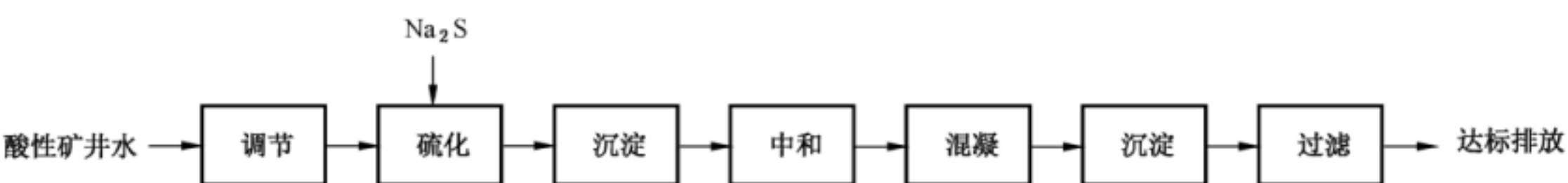
图 D.12 含其他重金属酸性矿井水硫化-中和法基本处理工艺
